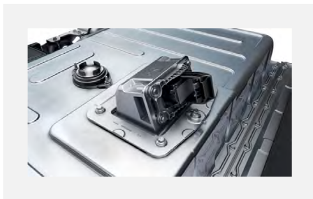
Obrázok 1. Elektrická trakčná batéria Renault Megane E-Tech so systémom Fireman Access a service plug
